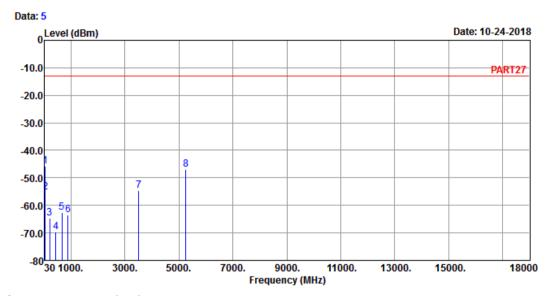
Site : 966 Chamber 5 Condition: PART27 HORIZONTAL Remark : WCDMA Band 4 Link\_H-CH
