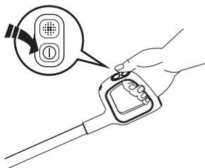
Appuyez sur le bouton ① pour que l'appareil démarre en mode AUTO par défaut. Appuyez à nouveau sur ce bouton pour éteindre l'appareil. Alternez entre les modes AUTO, MAX et SUCTION en appuyant sur le bouton ②.
