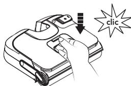
Remettez le réservoir dans l'appareil. Vous entendrez un clic lorsque le réservoir est bien en place.
