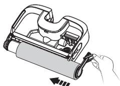
Remettez le rouleau brosse en place en insérant son extrémité dans le côté gauche du support, puis fixez la languette du rouleau à la boucle magnétique à droite pour la verrouiller en place.
