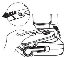
Appuyez sur le bouton de déverrouillage du réservoir d'eau propre pour le retirer de l'appareil.
