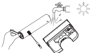
Utilisez l'outil de nettoyage pour retirer les cheveux et les débris enroulés autour du rouleau et rincez celui-ci ainsi que l'arrière du REP à l'eau. Laissez-les sécher complètement avant de les remettre en place.
