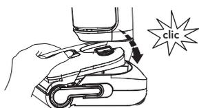
Remplacez le réservoir dans l'appareil. Vous entendrez un clic lorsque le réservoir est bien en place.
