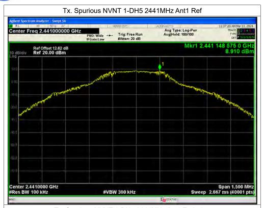
Tx. Spurious NVNT 1-DH5 2441MHz Ant1 Emission
