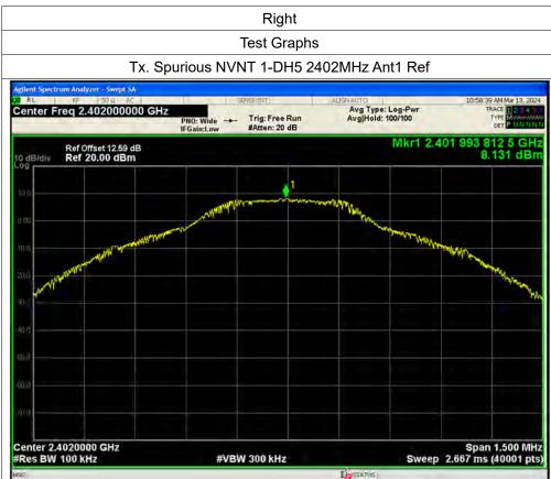
Tx. Spurious NVNT 1-DH5 2402MHz Ant1 Emission
