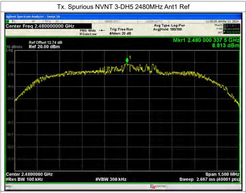
Tx. Spurious NVNT 3-DH5 2480MHz Ant1 Emission
