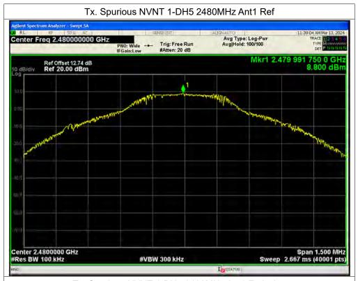
Tx. Spurious NVNT 1-DH5 2480MHz Ant1 Emission
