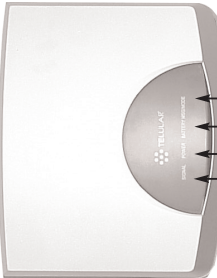
Figura 7 – LED indicadores del SX4T.
