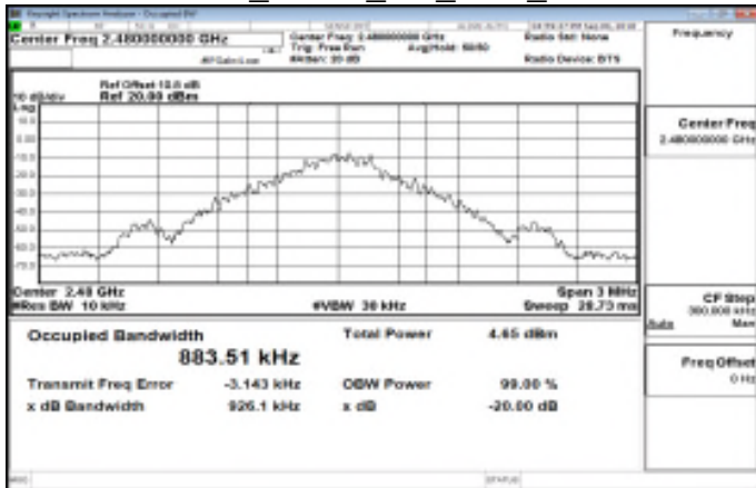
OBW 20dB GFSK 1M DH5 2480MHz
