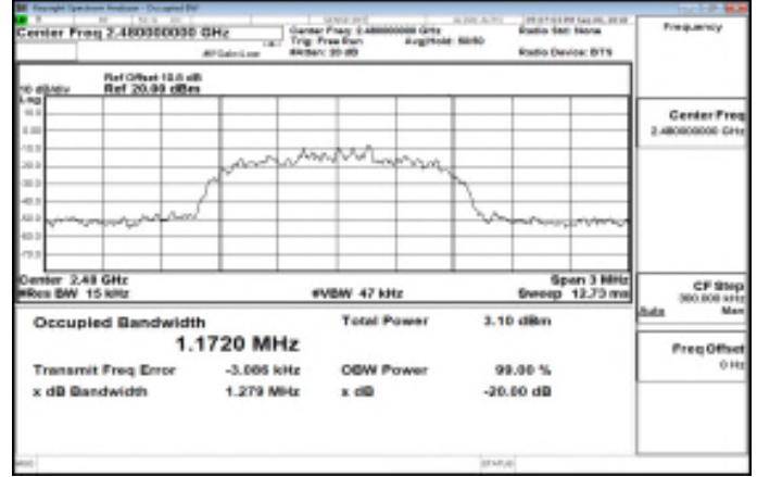
OBW 20dB \pi 4DQPSK 2M DH5 2480MHz
