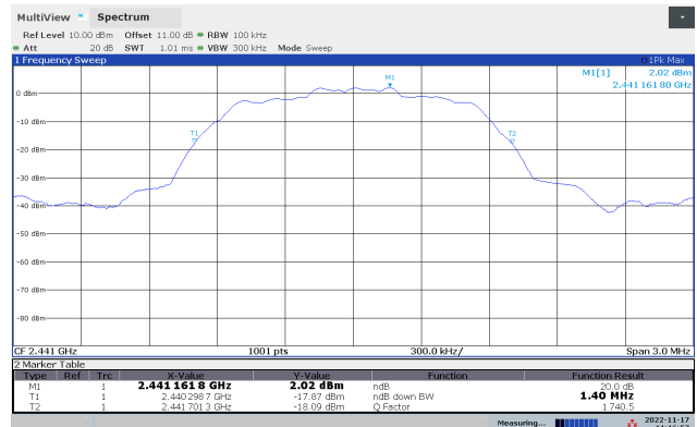
20dB Bandwidth 2441 MHz, \pi/4 -DPSK
