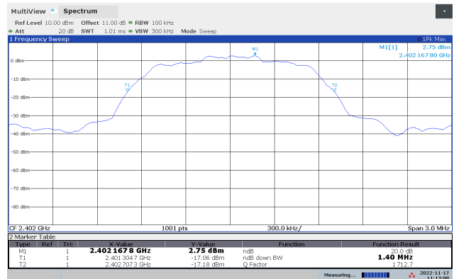
20dB Bandwidth 2402 MHz, \pi/4 -DPSK
