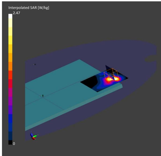
**12. LTE Band 66, QPSK - 20MHz, CH132572 – Back Face**
