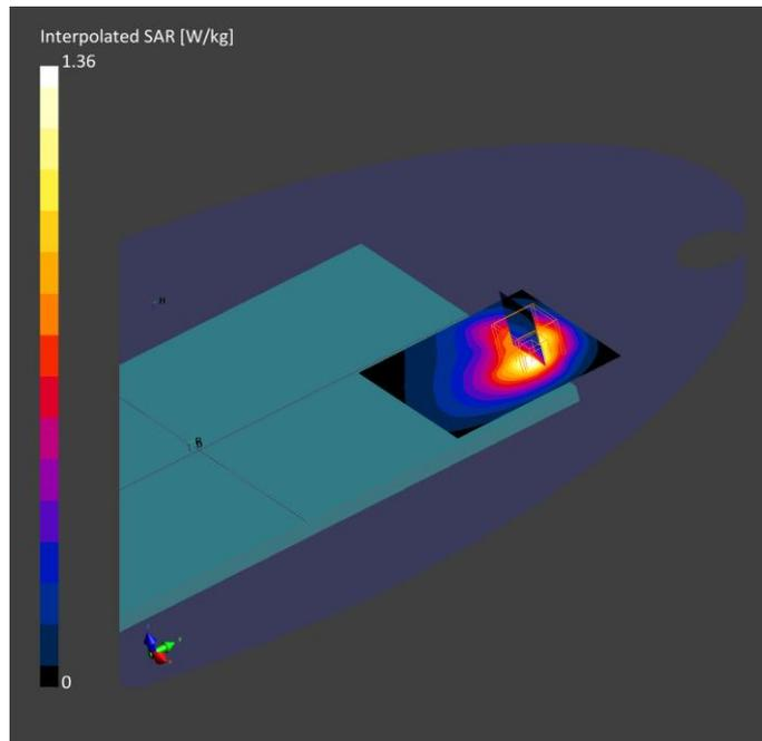
**4. LTE Band 2, QPSK - 20MHz, CH19100 – Back Face**
