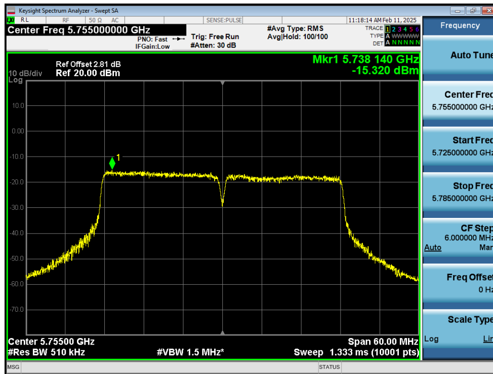
PSD NVNT n40 5755MHz Ant1
