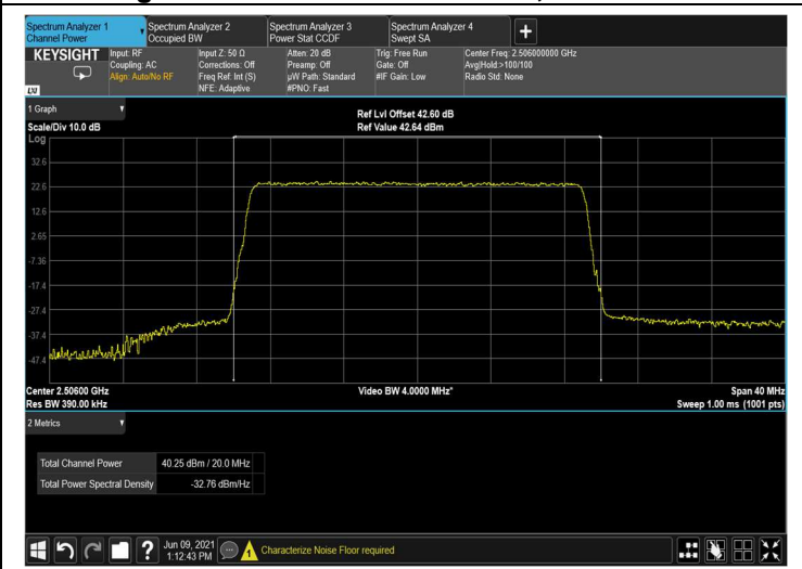
Figure 71: 64QAM 20MHz B.W.; 2506.0MHz
