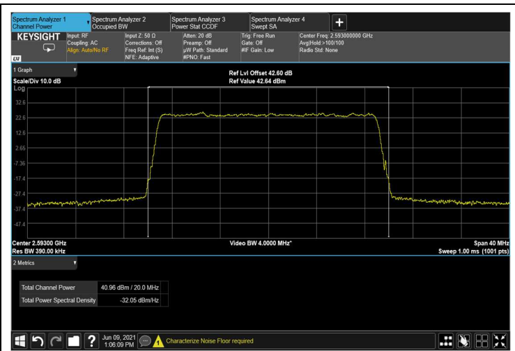
Figure 69: 16QAM 20MHz B.W.; 2593.0MHz
