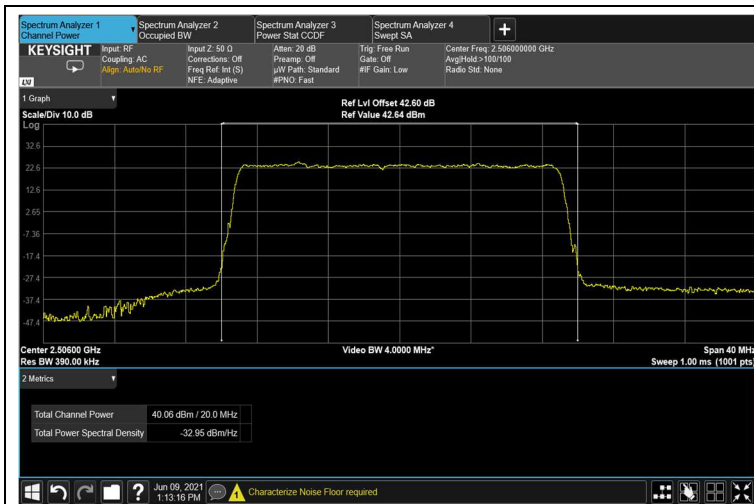
Figure 68: 16QAM 20MHz B.W.; 2506.0MHz
