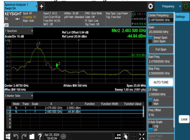
Band Edge BLE 2M HighCH39-2480MHz
