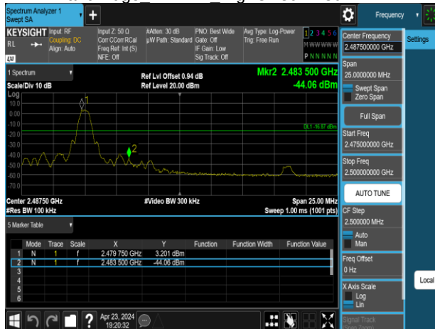
Band Edge BLE 1M HighCH39-2480MHz
