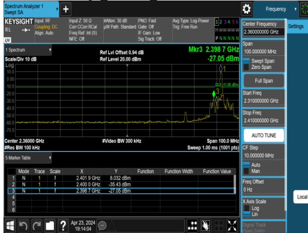
Band Edge BLE 1M HighCH39-2480MHz
