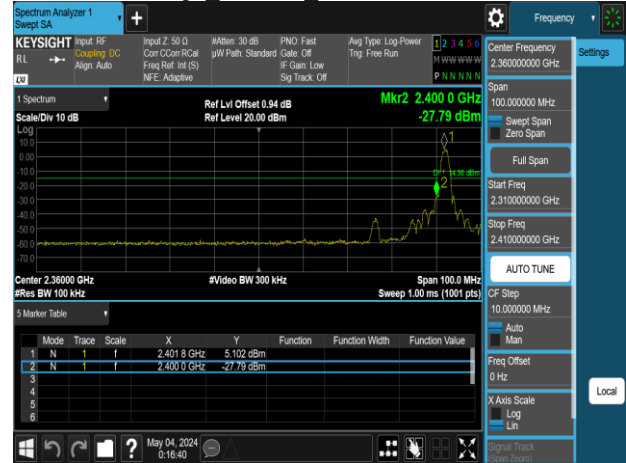
Band Edge BLE 2M HighCH39-2480MHz
