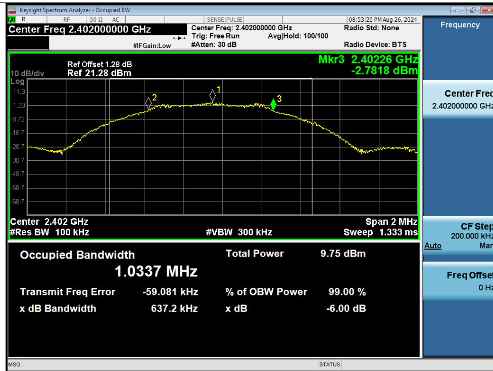
-6dB Bandwidth NVNT BLE 1M 2440MHz Ant1
