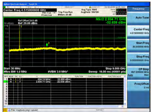
Band26 / 10MHz / Low CH / 64QAM
