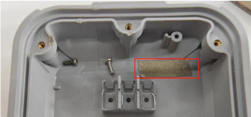
标记红框区域增加导电布（尺寸：长 27mm 宽 9mm）
