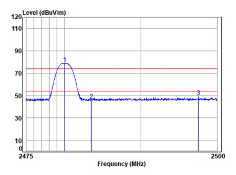
Site : chamber Condition: 3m VERTICAL Job No : 00152AT/00153AT Mode : 2480 Band edge
