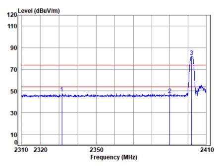
Site : chamber Condition: 3m VERTICAL Job No : 00152AT/00153AT Mode : 2402 Band edge
