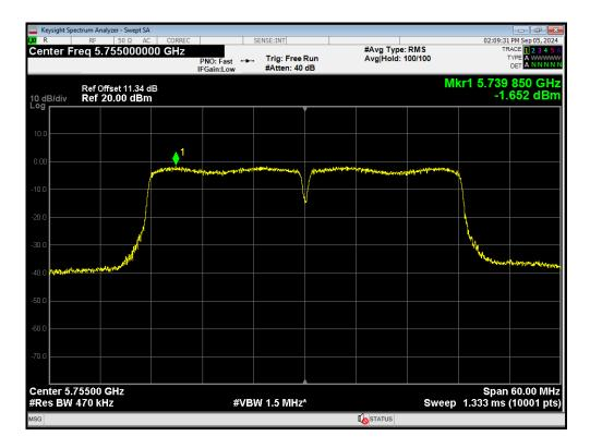
PSD 802.11ac(VHT40) 5795MHz
