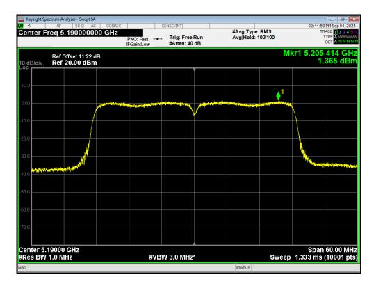
PSD 802.11ac(VHT40) 5230MHz
