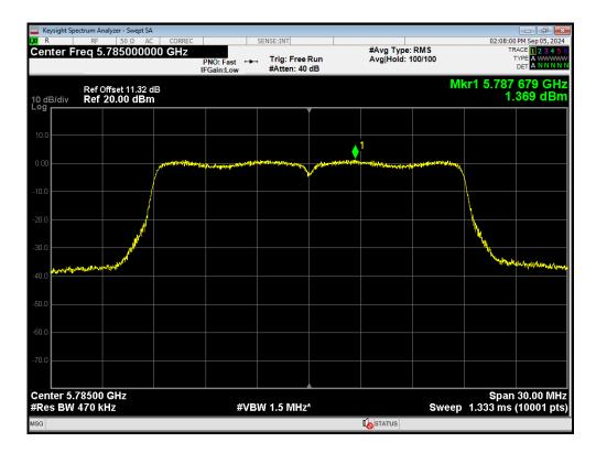
PSD 802.11ac(VHT20) 5825MHz
