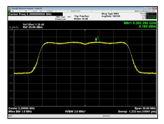
PSD 802.11ac(VHT20) 5240MHz
