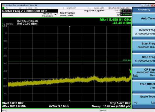
U-NII-2c ,Plot 2,30MHz~5470MHz-802.11 n(20MHz),5580MHz,Ant1
