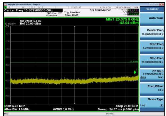
U-NII-2c ,Plot 3,5725MHz~26000MHz-802.11n(40MHz),5670MHz,Ant1
