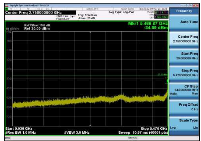
U-NII-2c ,Plot 2,30MHz~5470MHz-802.11 ac(20MHz),5700MHz,Ant1
