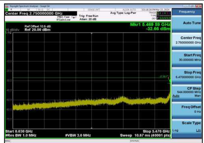
U-NII-2c ,Plot 2,30MHz~5470MHz-802.11 n(20MHz),5700MHz,Ant1
