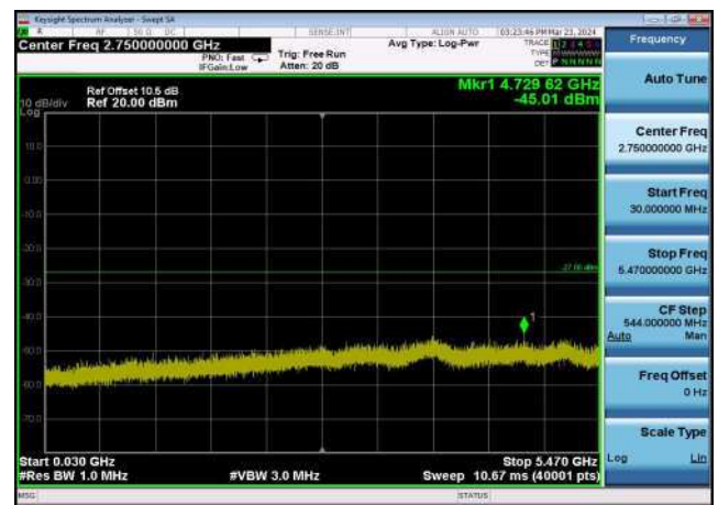
U-NII-2c ,Plot 2,30MHz~5470MHz-802.11 ac(40MHz),5550MHz,Ant1
