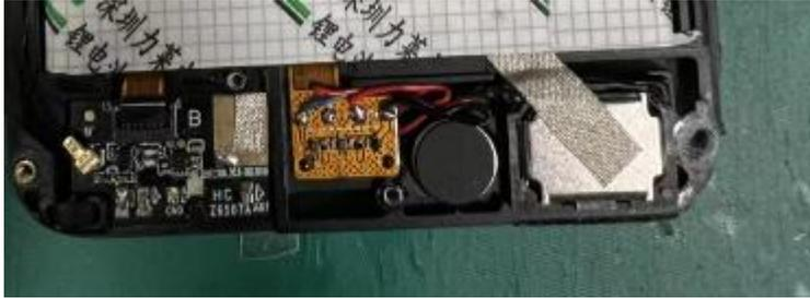
喇叭贴导电布接地，小板漏铜区贴导电泡棉接地，马达接地，屏的 FPC 贴导电布屏蔽
