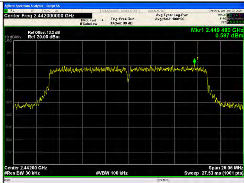
PSD NVNT n20 2442MHz Ant1
