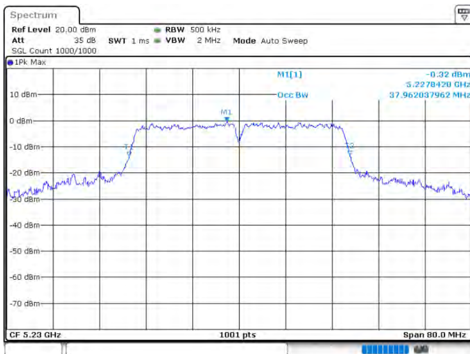
OBW NVNT 802.11n(HT40) 5230MHz Ant 2
