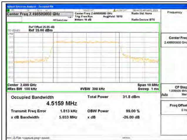
Band41 / 5MHz / QPSK/ Low CH
