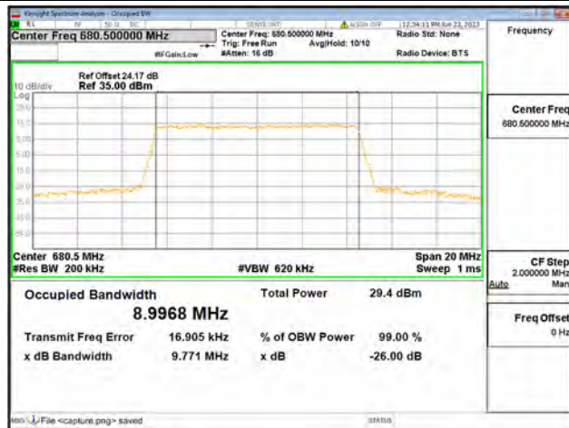
Band71 / 10MHz / 64QAM/ Mid CH
