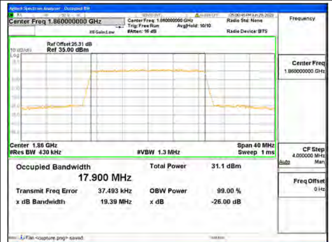
Band25 / 20MHz / QPSK/ Low CH
