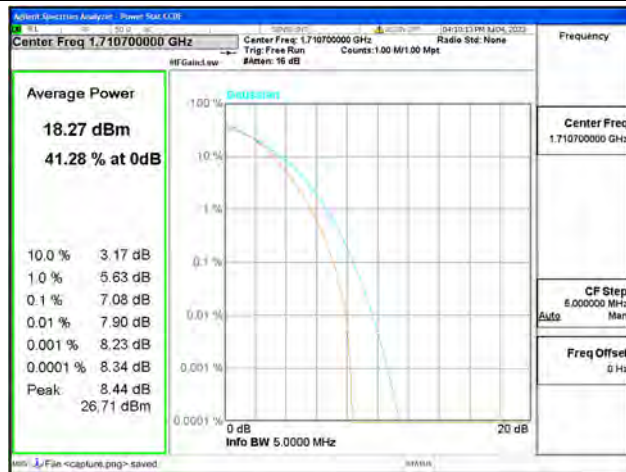
Band4 / 1.4MHz / Low CH / 64QAM
