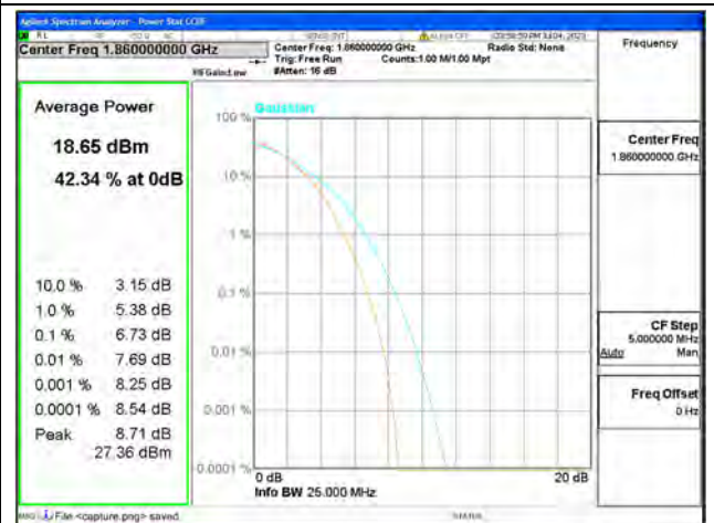
Band2 / 20MHz / Low CH / 64QAM
