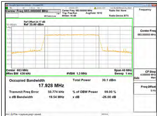
Band71 / 20MHz / QPSK/ Mid CH
