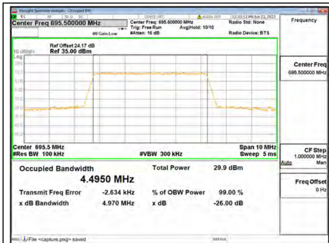
Band71 / 5MHz / QPSK/ High CH
