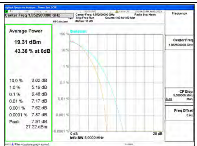
Band25 / 5MHz / Low CH / 16QAM
