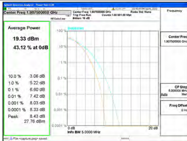
Band2 / 5MHz / High CH / 64QAM
