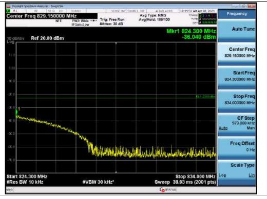
Spurious / ESMR / Uplink / LTE 5 MHz / High / High Edge ~ High Edge + 10 MHz
