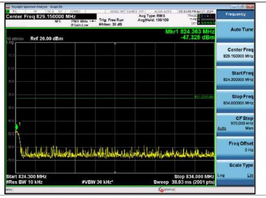
Spurious / ESMR / Uplink / GSM / High / High Edge ~ High Edge + 10 MHz
