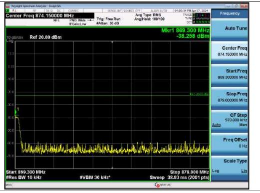
Spurious / ESMR / Downlink / GSM / High / High Edge ~ High Edge + 10 MHz
