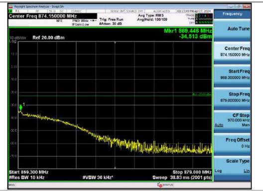
Spurious / ESMR / Downlink / LTE 5 MHz / High / High Edge ~ High Edge + 10 MHz
