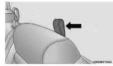
**Center Tether Anchorage Over Head Rest**
