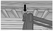
**Aligning Gate To Slots**
