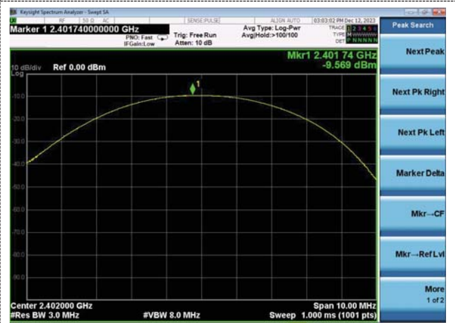
\pi/4 DQPSK (CH39)
