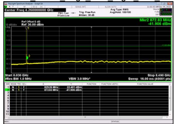
N5(5M)_DFT-s- OFDM QPSK Edge 1RB Right Low CH
