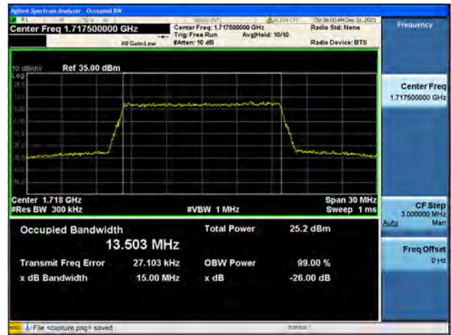
Band4 / 15MHz / Mid CH / QPSK
