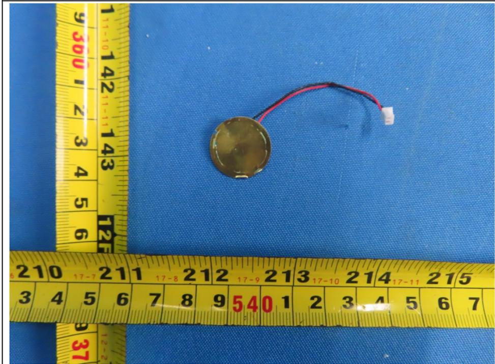
06. Piezo Buzzer 壓電蜂鳴器 (背面)
