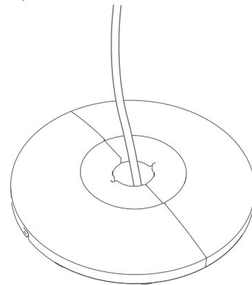
5. Passez le cordon d'alimentation dans le trou de l'écrou de vis puis serrez la vis avec la plaque de base.
