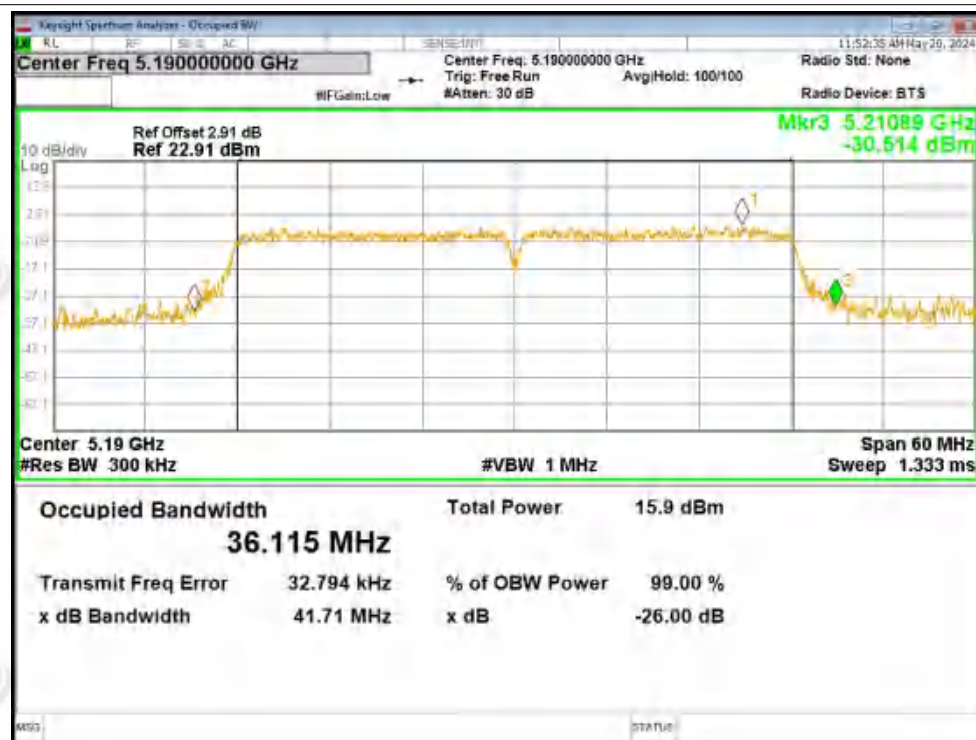
-26dB Bandwidth NVNT ac40 5230MHz Ant1
