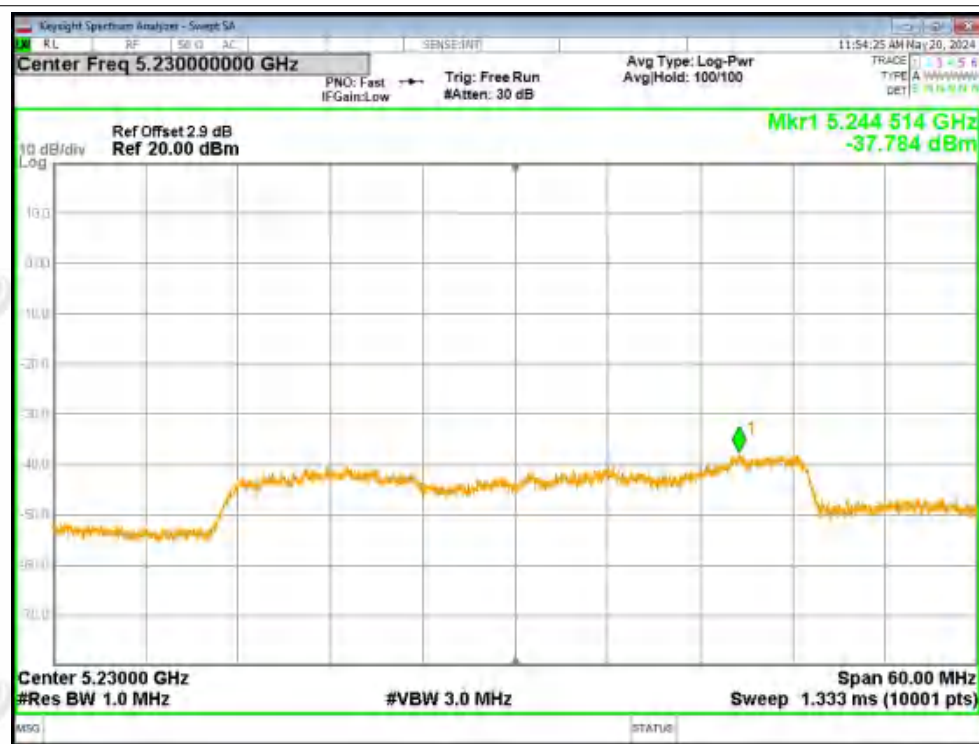
PSD NVNT ac40 5230MHz Ant1
