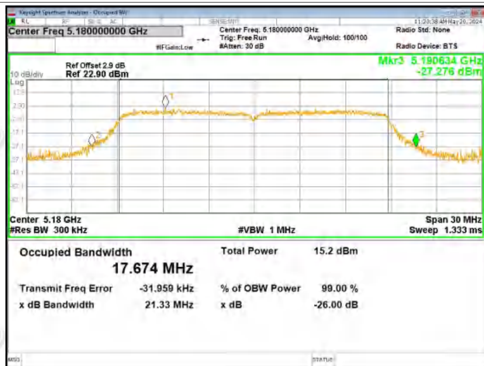
-26dB Bandwidth NVNT ac20 5200MHz Ant1
