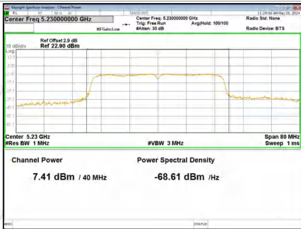
Power NVNT n40 5230MHz Ant1
