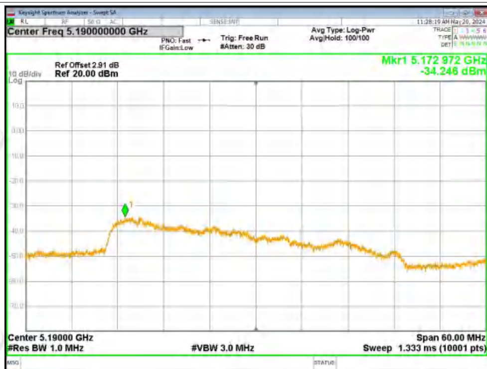
PSD NVNT n40 5230MHz Ant1
