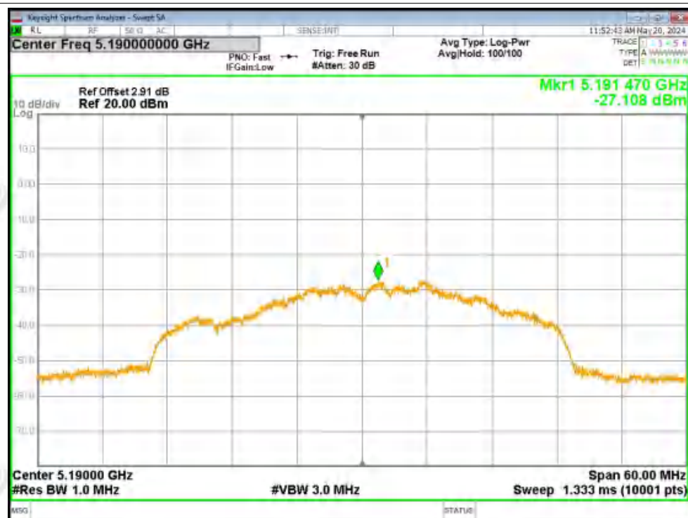
PSD NVNT ac40 5230MHz Ant1
