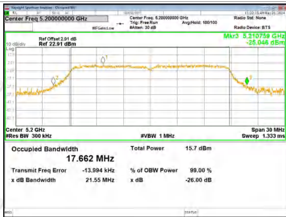
-26dB Bandwidth NVNT ac20 5200MHz Ant1
