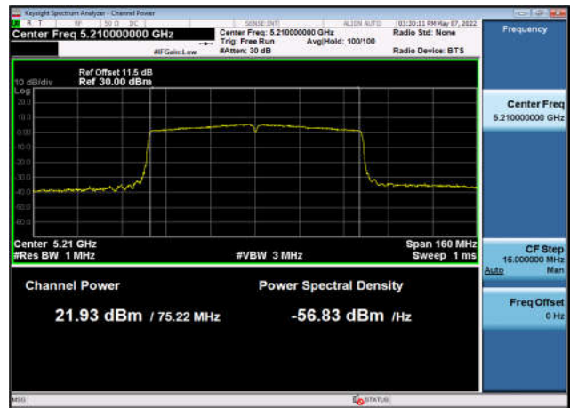
U-NII-1 Output Power-802.11n(20MHz) ,5220MHz,Ant2
