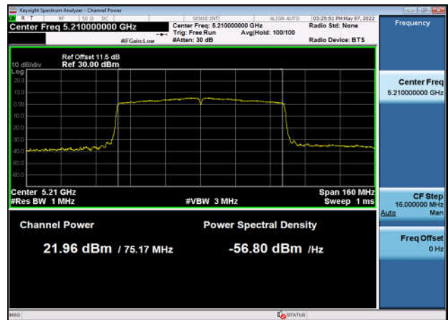
U-NII-1 Output Power-802.11ax(20MHz) ,5220MHz,Ant1
