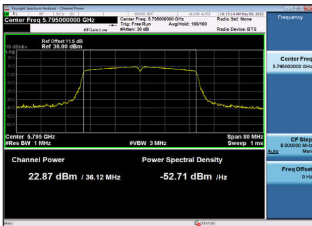
U-NII-3 Output Power-802.11n(20MHz) ,5745MHz,Ant1
