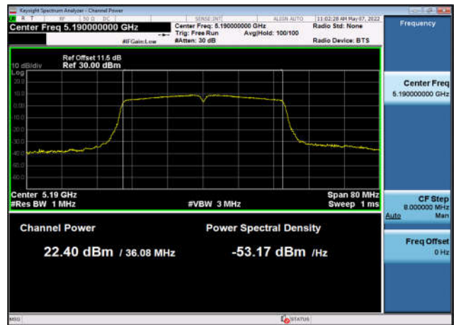
U-NII-1 Output Power-802.11ac(40MHz) ,5190MHz,Ant0
