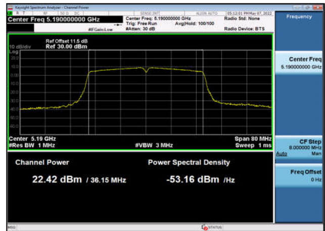
U-NII-1 Output Power-802.11ac(80MHz) ,5210MHz,Ant2
