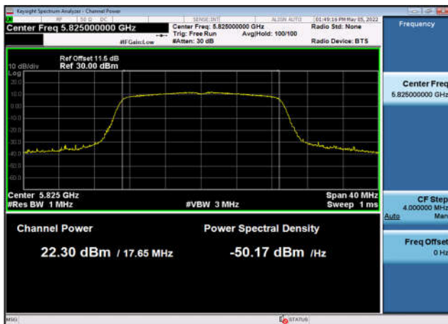
U-NII-3 Output Power-802.11ac(40MHz) ,5795MHz,Ant0
