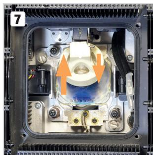
8. Inserire la nuova lampada nel telaio di supporto con lo stesso orientamento. Assicurarsi che il supporto inferiore a molla sia di nuovo nella posizione di fermo e serrare nuovamente le due viti del supporto superiore.
