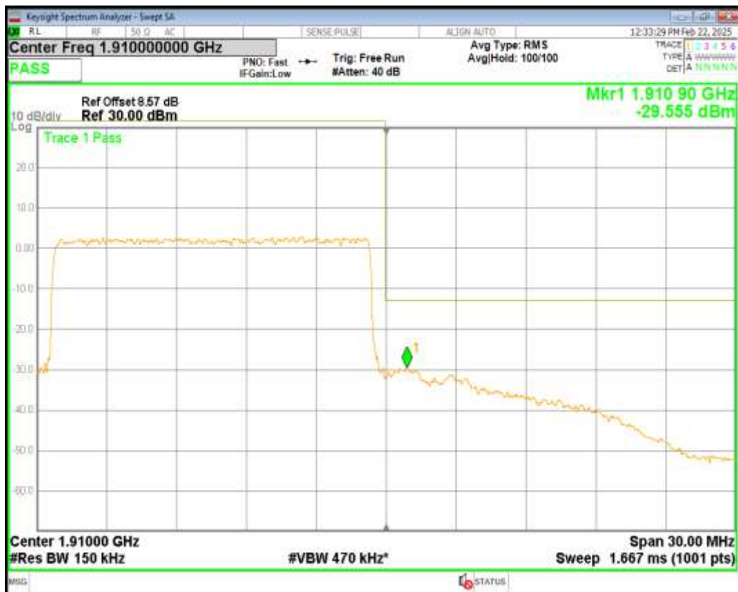
Band2 QPSK BW=20MHz Channel=18700 RB Size=100 Position=#0
