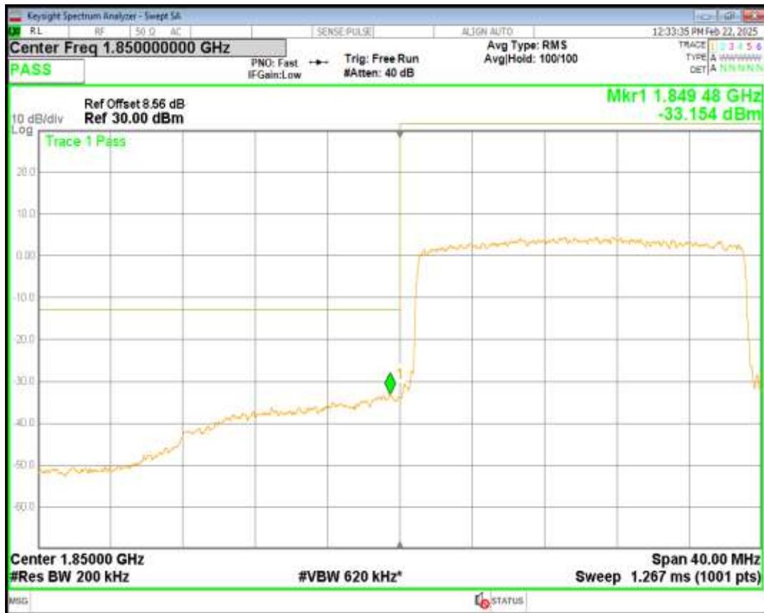
Band2 16QAM BW=20MHz Channel=18700 RB Size=100 Position=#0
