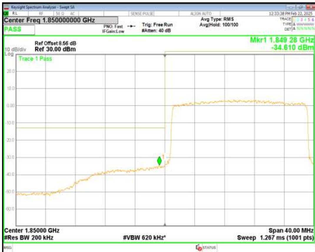
Band2 QPSK BW=20MHz Channel=19100 RB Size=100 Position=#0
