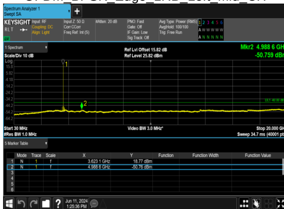
B2_N48(5M)_DFT-s-OFDM BPSK Edge 1RB Left Mid CH
