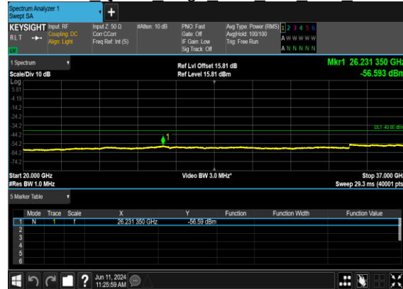
B2_N48(5M)_DFT-s-OFDM QPSK Edge 1RB Left Low CH
