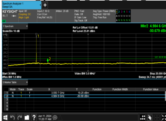
B2_N48(5M)_DFT-s-OFDM QPSK Edge 1RB Left Low CH
