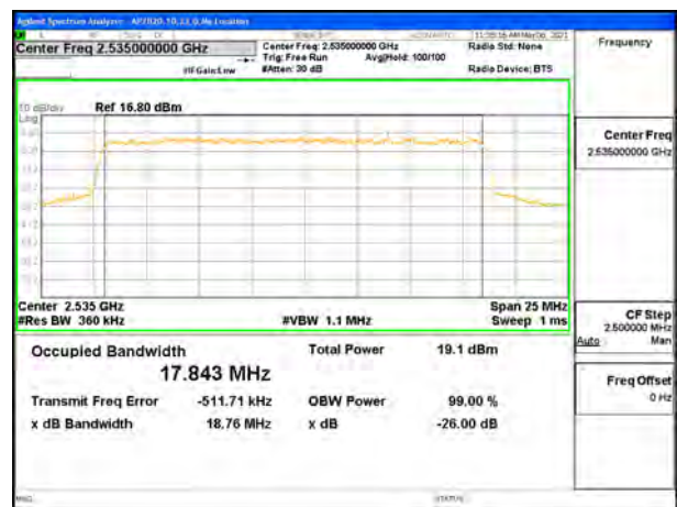
5G NR n7 20MHz BPSK Middle Channel RB100-0
