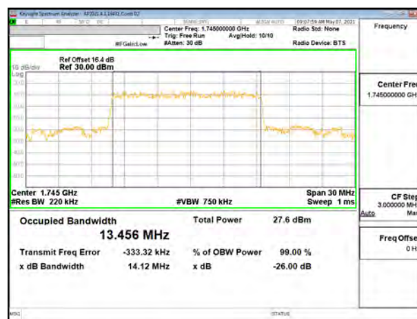
5G NR n66 15MHz BPSK Middle Channel RB75-0
