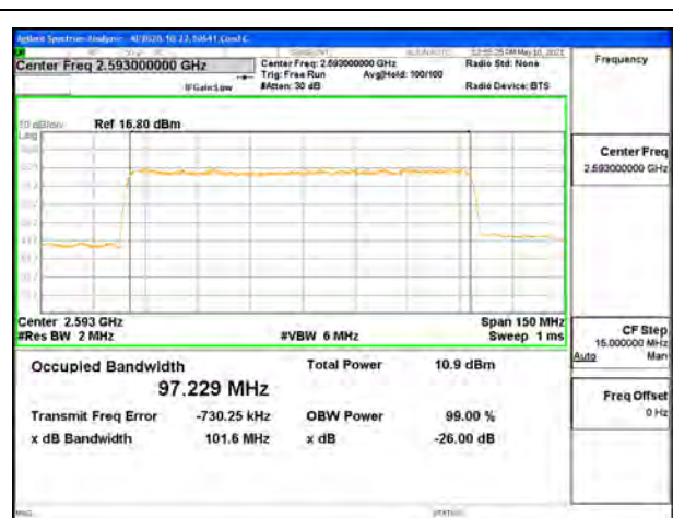
5G NR n41 100MHz BPSK Middle Channel RB270-0
