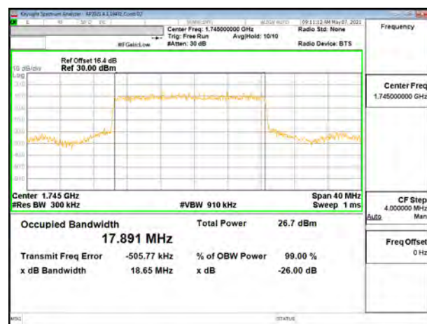
5G NR n66 20MHz BPSK Middle Channel RB100-0
