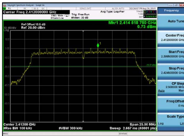
,Plot 1,Reference Level-802.11n(HT20) ,2462MHz
