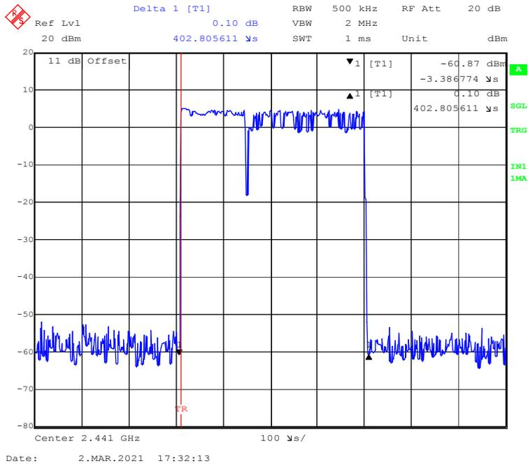
**EDR ( $\pi/4$ -DQPSK):Pulse time, High Channel, 2DH1**
