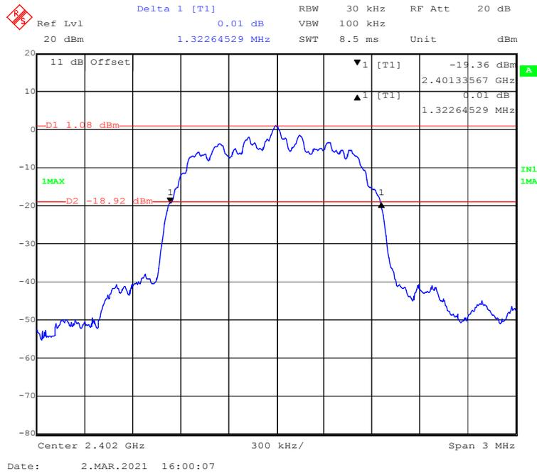
**EDR( $\pi/4$ -DQPSK): Middle Channel**
