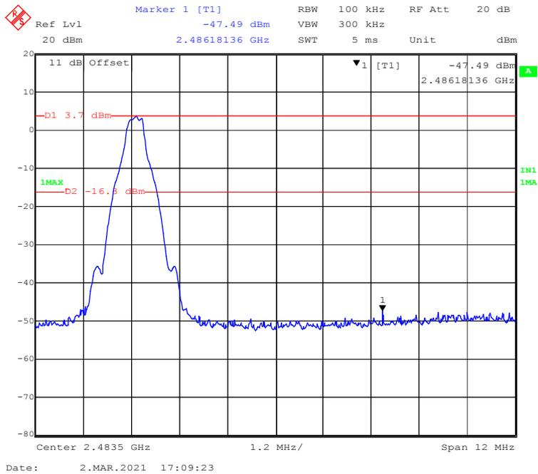
**EDR ( $\pi/4$ -DQPSK): Left Side - Transmitting**
