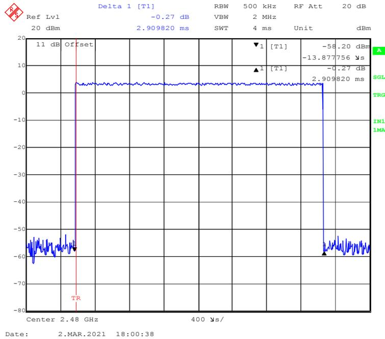
**EDR ( $\pi/4$ -DQPSK): Pulse time, Low Channel, 2DH1**
