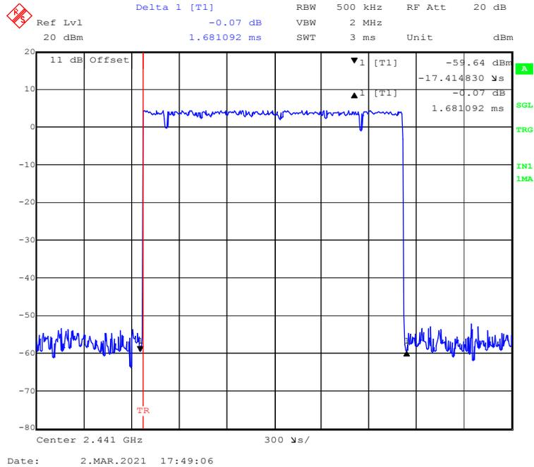
**EDR ( $\pi/4$ -DQPSK):Pulse time, High Channel, 2DH3**
