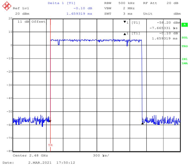
**EDR ( $\pi/4$ -DQPSK):Pulse time, Low Channel, 2DH5**
