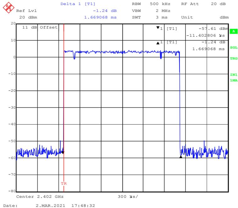
**EDR ( $\pi/4$ -DQPSK):Pulse time, Middle Channel, 2DH3**
