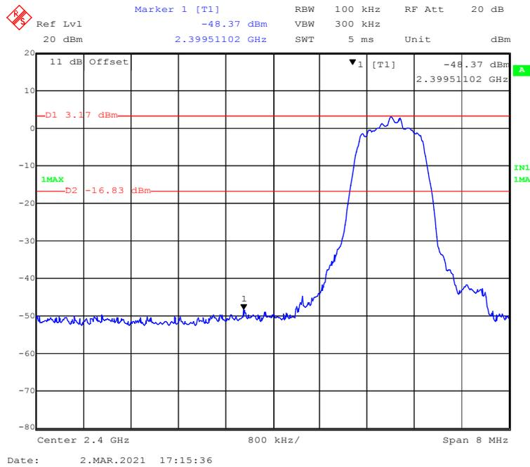
**EDR ( $\pi/4$ -DQPSK): Right Side - Transmitting**
