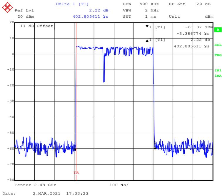
**EDR ( $\pi/4$ -DQPSK):Pulse time, Low Channel, 2DH3**
