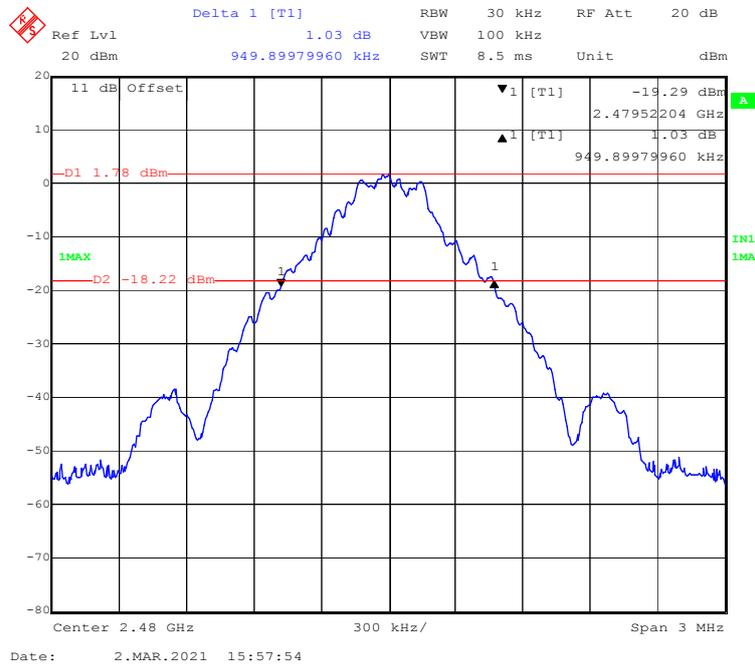
**EDR ( $\pi/4$ -DQPSK): Low Channel**
