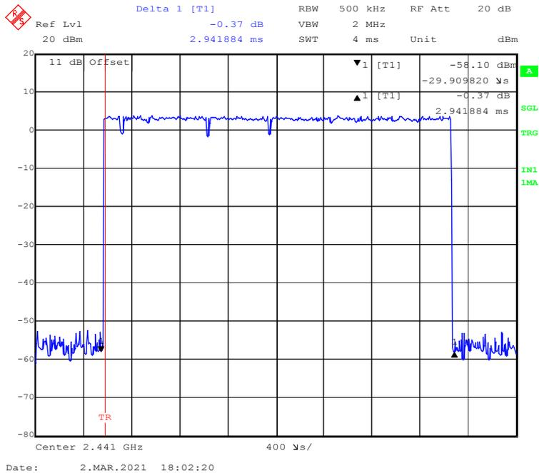
**EDR ( $\pi/4$ -DQPSK):Pulse time, High Channel, 2DH5**
