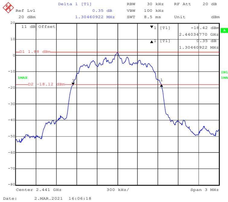
**EDR ( $\pi/4$ -DQPSK): High Channel**
