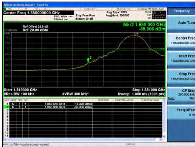
Band2 / 10MHz / High CH / QPSK / 1 RB
