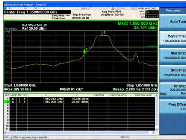
Band2 / 1.4MHz / High CH / QPSK / 1 RB
