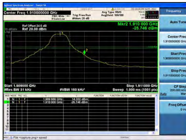
Band2 / 5MHz / High CH / QPSK / 1 RB
