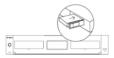
注意:请勿在设备通电的状态下装载或更换硬盘,以免造成设备或硬盘数据损坏,如果是全新硬盘,请先格式化硬盘再装载至设备,本机支持硬盘格式为:EXT3,EXT4,NTFS,FAT32,EXFAT。
