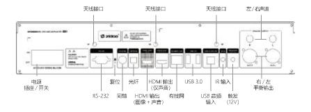
天线安装说明:请将附件中的天线安装至上图所示的天线接口。
