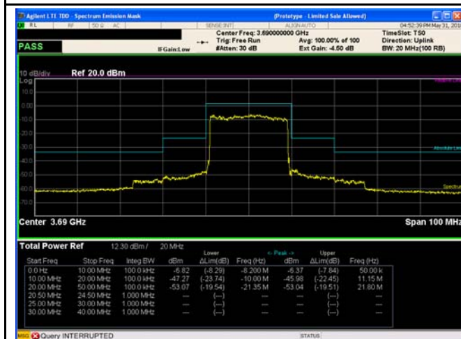
20MHz - Middle CH QPSK
