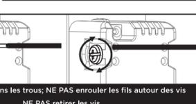
Insérez les fils dans les trous; NE PAS enrouler les fils autour des vis
