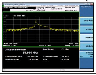
NB-IoT Band 13 QPSK 15KHz 1@0 CH-High
