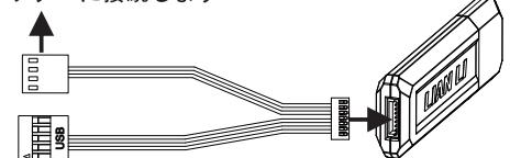
Connect to MB USB 2.0 header/Connectez au connecteur USB 2.0 de la carte mère/連接到主板 USB 2.0 接头/连接到主板 USB 2.0 接头/MB USB 2.0 ヘッダーに接続します
