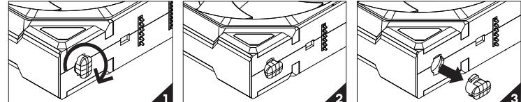
**Note!** If the radiator outlet interferes with the fan interlocking key, you can remove them/Si la sortie du radiateur interfère avec la clé d'interverrouillage du ventilateur, vous pouvez les retirer/若遇到水冷排出水位置影響風扇扣鎖，可將風扇扣鎖移除/ラジエーター出口がファン運動キーと干渉する場合、それを取り外すことができます
