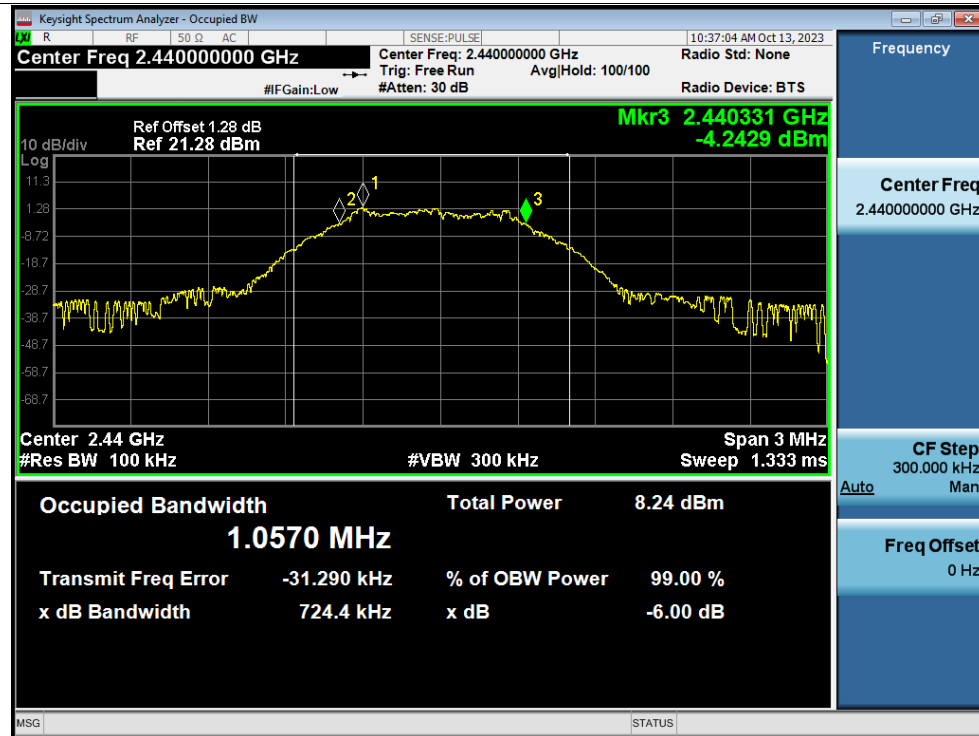
-6dB Bandwidth NVNT BLE 1M 2440MHz Ant1
