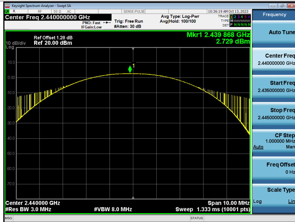
Power NVNT BLE 1M 2440MHz Ant1
