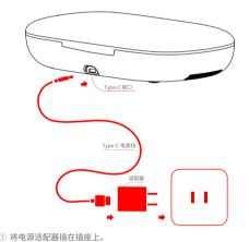
② Type-C 电源线一端连接适配器,一端连接无线充电消毒盒充上。
