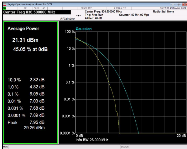
n26(824-849) SCS=15kHz DFT_16QAM BW=20MHz Channel=167300 RB=100@0
