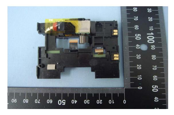
WLAN / BT Module (Model No.: Frey M1-0010, Frey M1-0000)
