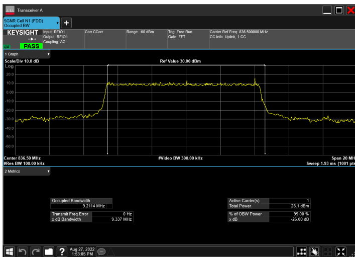
DC_2A_n5A_10MHz|10MHz_15kHz_1880MHz|836.5MHz_QP SK|CP-OFDM QPSK_RB1@50|RB52@0
