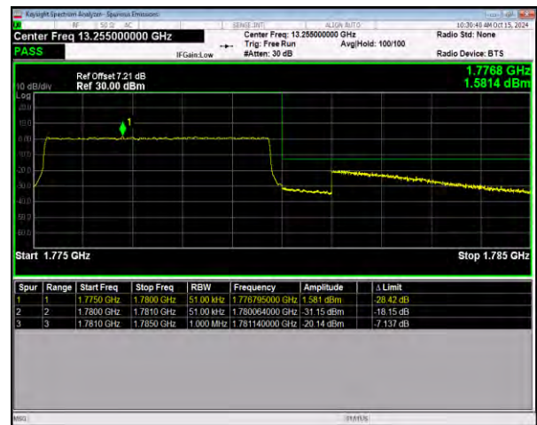
n66 SCS=15kHz CP_QPSK BW=5MHz HighChannel=355500 RB=25@0
