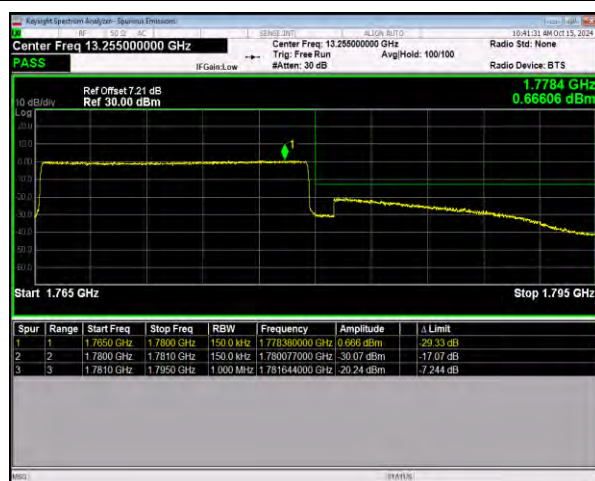
n66 SCS=15kHz CP_QPSK BW=15MHz HighChannel=354500
