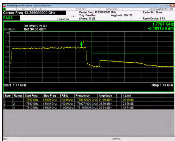
n66 SCS=15kHz DFT_256QAM BW=10MHz HighChannel=355000 RB=50@0
