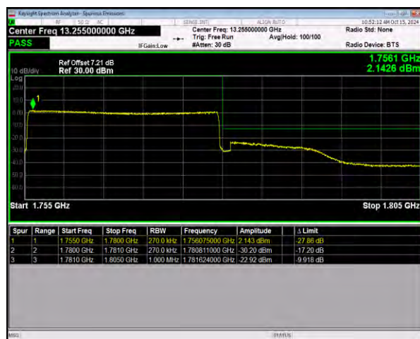
n66 SCS=15kHz CP_QPSK BW=25MHz HighChannel=353500 RB=133@0
