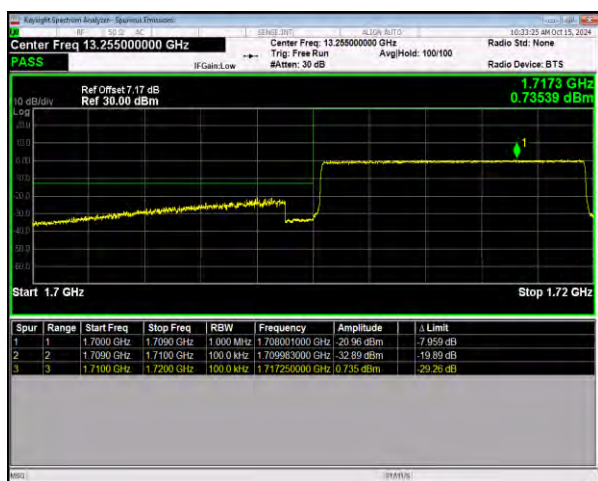
n66 SCS=15kHz CP_QPSK BW=10MHz LowChannel=343000
