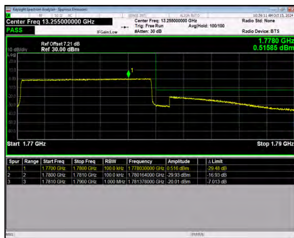
n66 SCS=15kHz CP_QPSK BW=10MHz HighChannel=355000 RB=52@0
