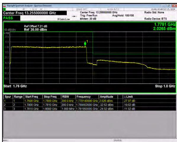
n66 SCS=15kHz DFT_64QAM BW=20MHz
