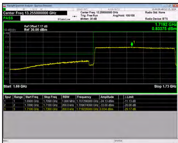
n66 SCS=15kHz CP_QPSK BW=20MHz LowChannel=344000
