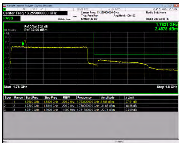
n66 SCS=15kHz DFT_16QAM BW=20MHz HighChannel=354000 RB=100@0
