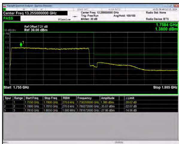
n66 SCS=15kHz DFT_256QAM BW=25MHz HighChannel=353500 RB=128@0
