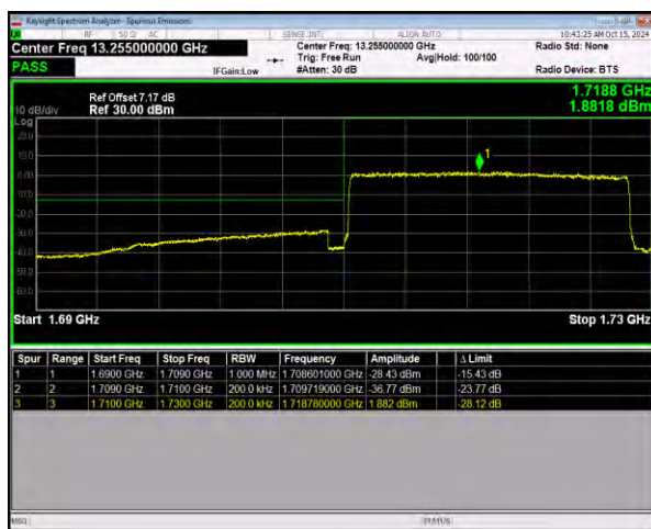
n66 SCS=15kHz DFT_64QAM BW=20MHz
