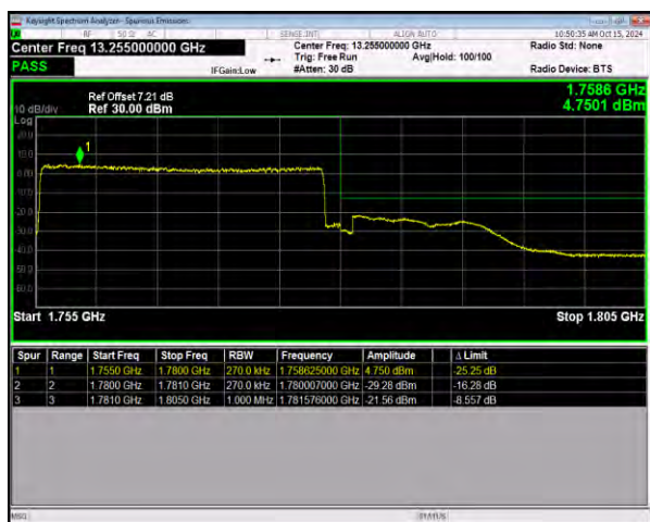
n66 SCS=15kHz DFT_QPSK BW=25MHz HighChannel=353500 RB=128@0
