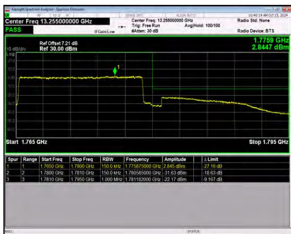
n66 SCS=15kHz DFT_16QAM BW=15MHz
