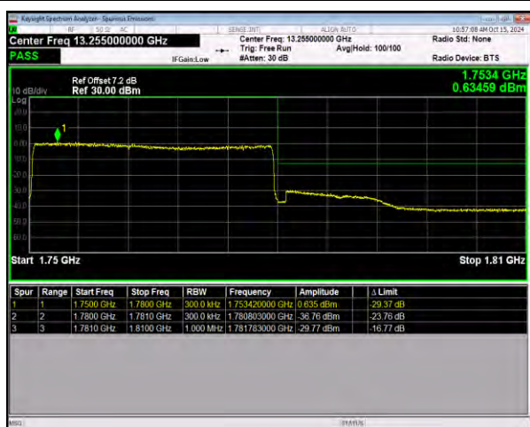
n66 SCS=15kHz DFT_256QAM BW=30MHz
