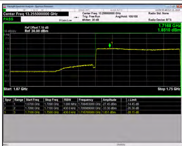
n66 SCS=15kHz CP_QPSK BW=40MHz LowChannel=346000
