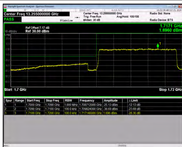
n66 SCS=15kHz DFT_64QAM BW=10MHz LowChannel=343000 RB=50@0
