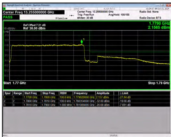
n66 SCS=15kHz DFT_16QAM BW=10MHz HighChannel=355000 RB=50@0
