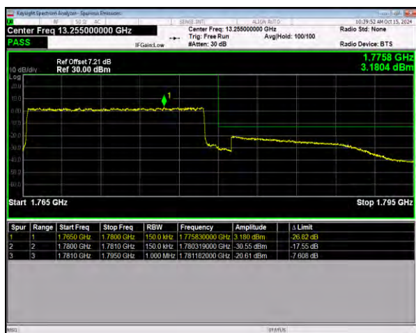
n66 SCS=15kHz DFT_QPSK BW=15MHz HighChannel=354500 RB=75@0
