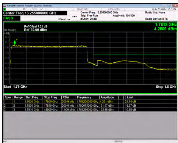
n66 SCS=15kHz DFT_BPSK BW=20MHz HighChannel=354000 RB=100@0
