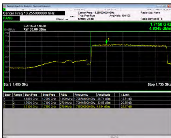
n66 SCS=15kHz DFT_BPSK BW=25MHz LowChannel=344500
