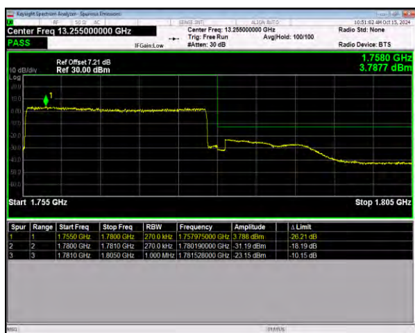
n66 SCS=15kHz DFT_16QAM BW=25MHz HighChannel=353500 RB=128@0
