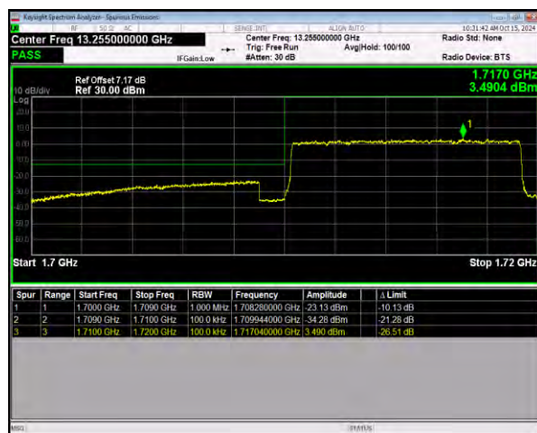
n66 SCS=15kHz DFT_QPSK BW=10MHz LowChannel=343000 RB=50@0
