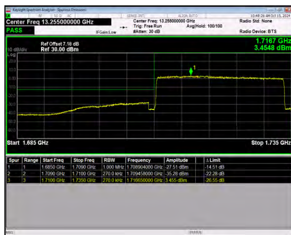
n66 SCS=15kHz DFT_16QAM BW=25MHz LowChannel=344500 RB=128@0
