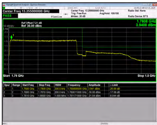
n66 SCS=15kHz DFT_QPSK BW=20MHz HighChannel=354000 RB=100@0
