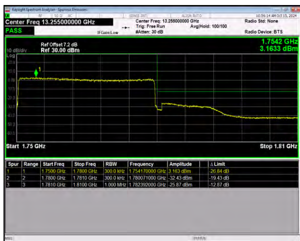
n66 SCS=15kHz DFT_16QAM BW=30MHz
