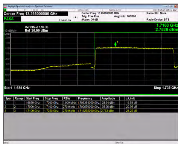
n66 SCS=15kHz DFT_64QAM BW=25MHz LowChannel=344500 RB=128@0
