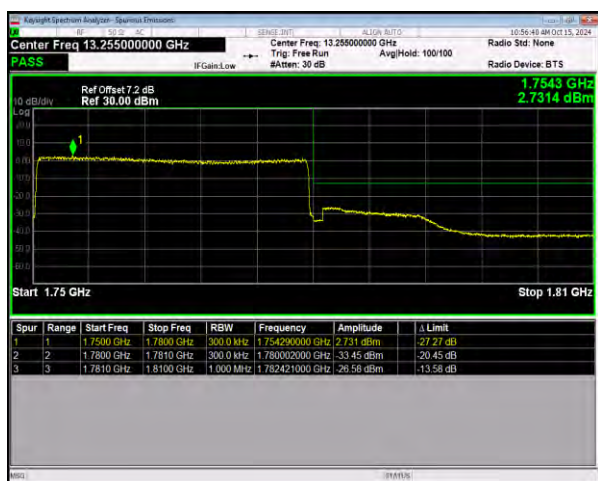
n66 SCS=15kHz DFT_64QAM BW=30MHz
