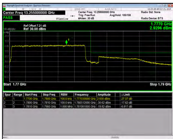
n66 SCS=15kHz DFT_QPSK BW=10MHz HighChannel=355000 RB=50@0
