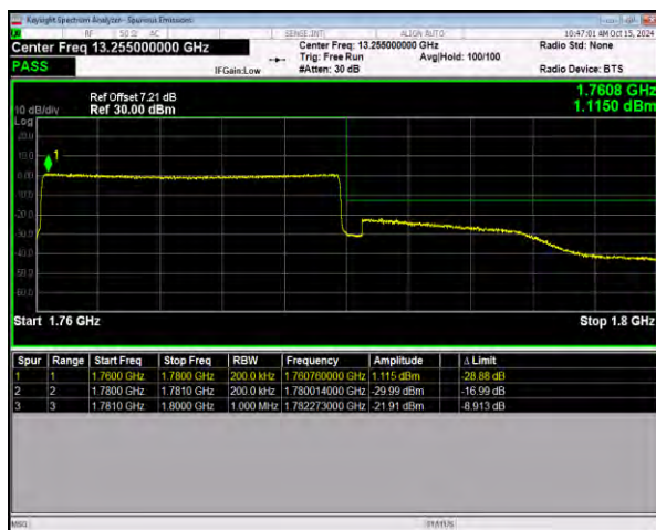
n66 SCS=15kHz CP_QPSK BW=20MHz HighChannel=354000
