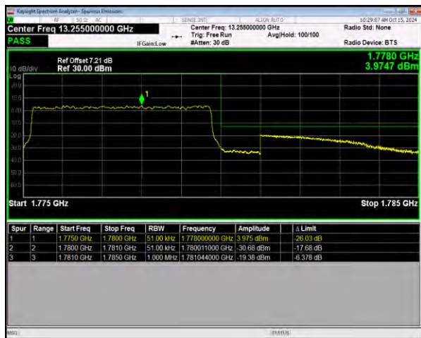
n66 SCS=15kHz DFT_QPSK BW=5MHz HighChannel=355500 RB=25@0
