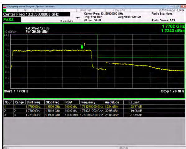
n66 SCS=15kHz DFT_64QAM BW=10MHz HighChannel=355000 RB=50@0
