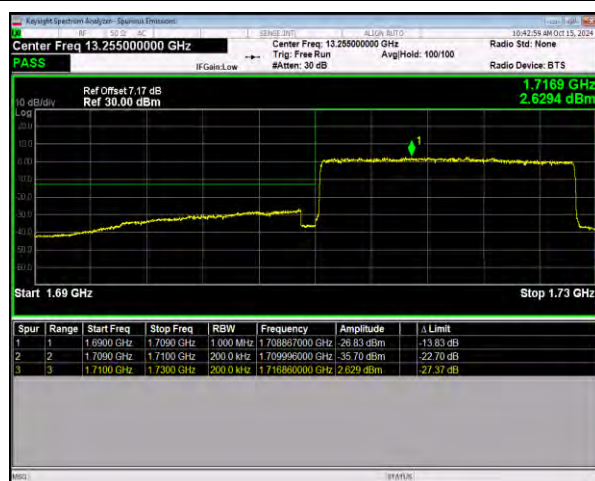
n66 SCS=15kHz DFT_16QAM BW=20MHz LowChannel=344000 RB=100@0
