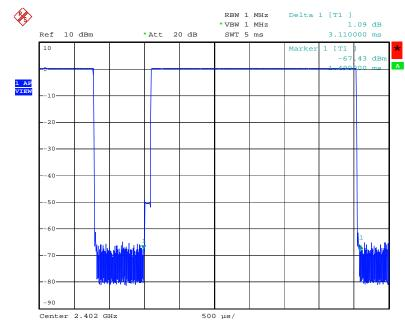
DH5 Modulation Type: GFSK (Channel 00) :
