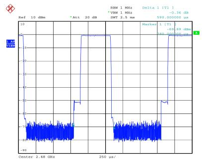
DH1 Modulation Type: GFSK (Channel 78) :
