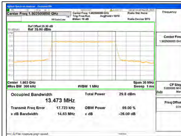
Band2 / 15MHz / QPSK / High CH
