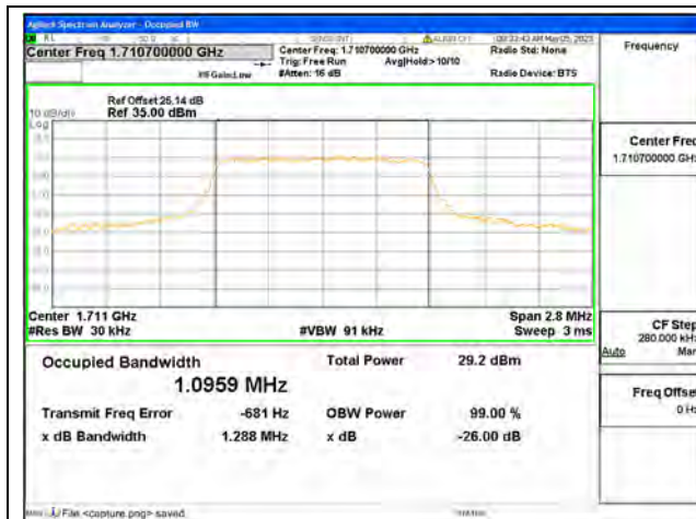
Band4 / 1.4MHz / QPSK/ Low CH
