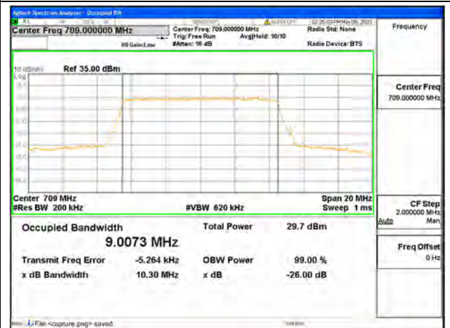
Band17 / 10MHz / QPSK/ Low CH
