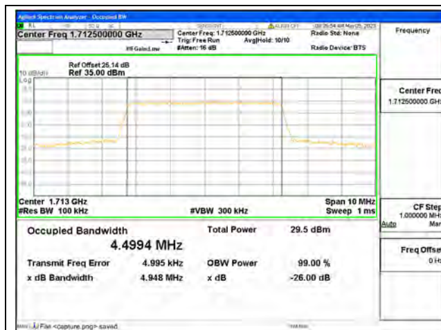
Band4 / 5MHz / QPSK/ Low CH
