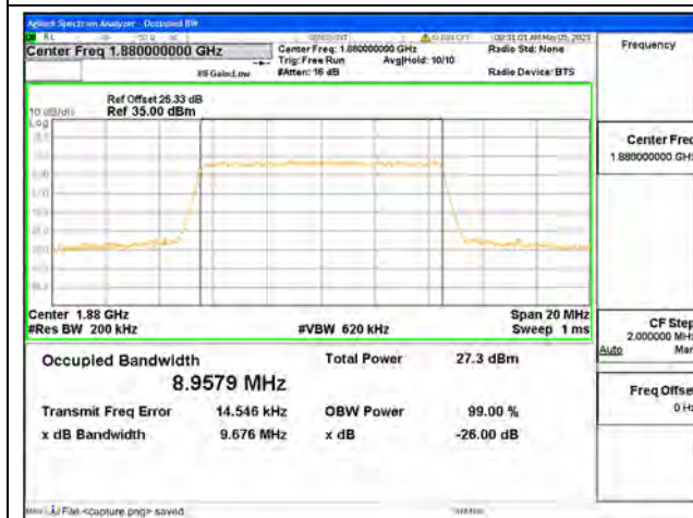
Band2 / 10MHz / 64QAM/ Mid CH
