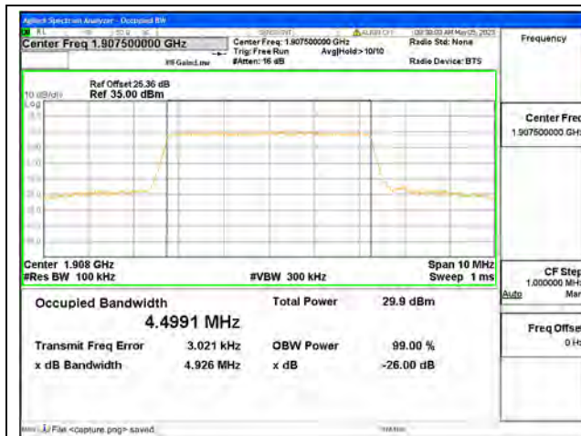
Band2 / 5MHz / QPSK/ High CH
