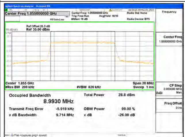
Band2 / 10MHz / QPSK/ Low CH
