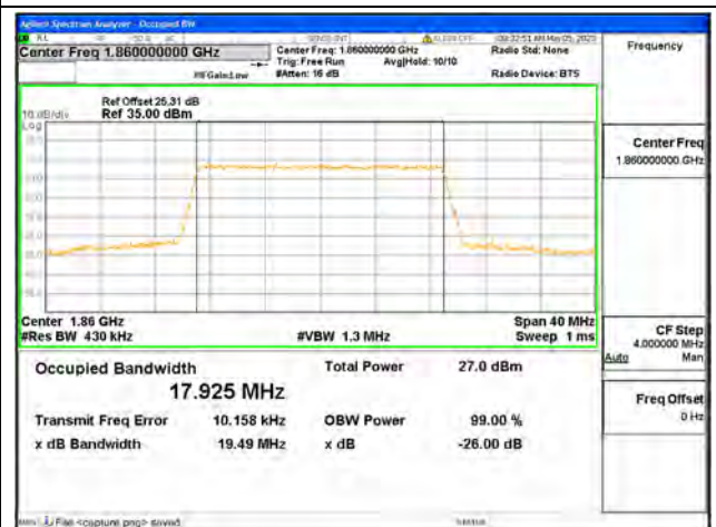
Band2 / 20MHz / 64QAM / Low CH
