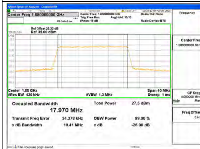
Band2 / 20MHz / 64QAM/ Mid CH
