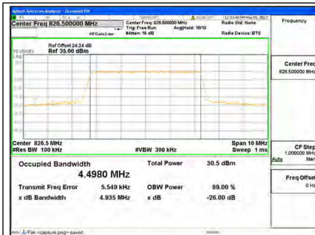
Band5 / 5MHz / QPSK/ Low CH
