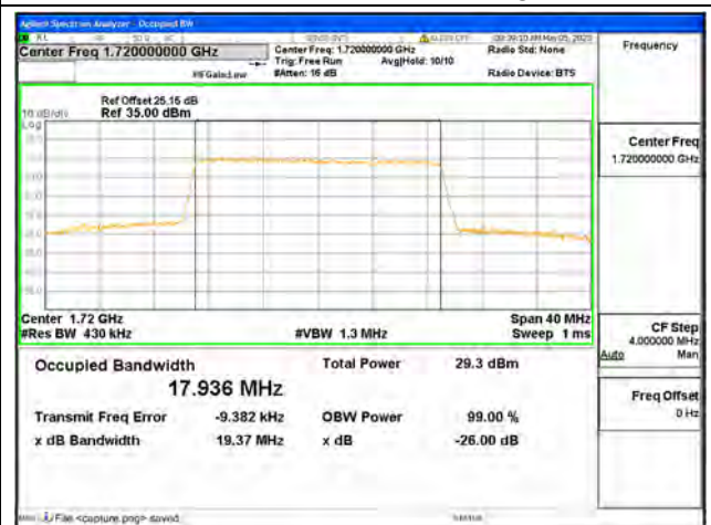
Band4 / 20MHz / QPSK/ Low CH
