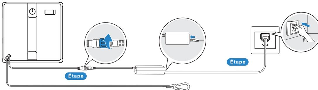
**Branchez correctement dans l'ordre indiqué ci-dessus. Un mauvais branchement peut entraîner des anomalies de charge ou endommager**
